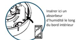
Insérer ici un absorbant d'humidité le long du bord intérieur
